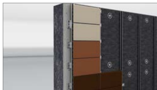
Monter les éléments KeraTwin® en rangées verticales
