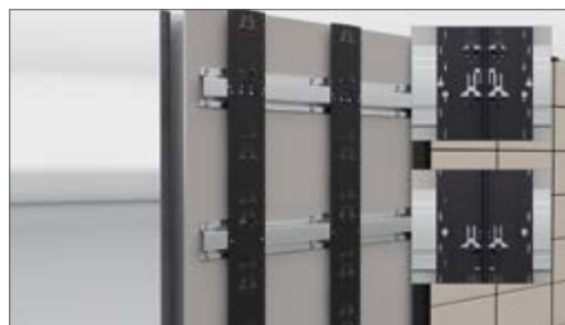
Fixer le profilé Omega avec un rivet aveugle en aluminium (n° d'art. 658) ou une vis en acier inoxydable A4 (n° d'art. 659) (attention à l'agencement des points fixes et flottants).
