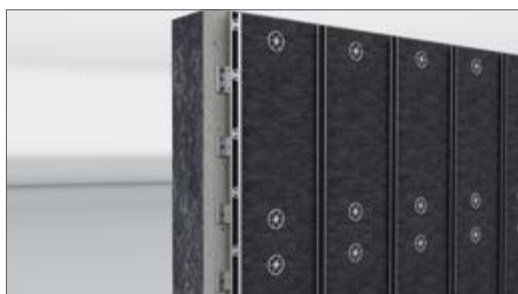
Fixer les agrafes de bordure au moyen de rivets aveugles n° d'art. 675-01
