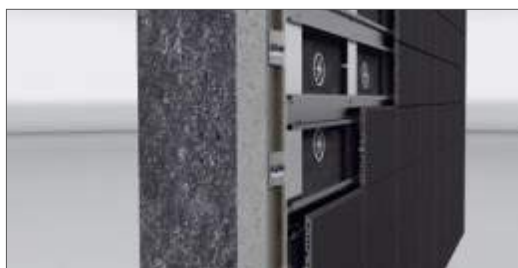
Accrocher les éléments KeraTwin® dans les profilés horizontales avec les adaptateurs – utiliser les entretoises de joints (n° d'art. 645) pour assurer la bonne position des éléments
