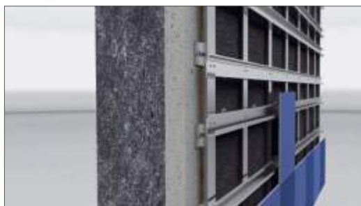
Accrocher les éléments KerAion® dans les rails horizontaux avec les agrafes au verso
