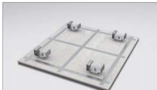
Visser les agrafes avec rondelles en caoutchouc n° d'art. 371 et écrous en acier inoxydable autobloquants (n° d'art. 370) sur les points de fixation Quadro au verso.
