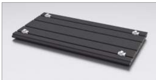
Glisser l'adaptateur (n° d'art. 596) dans les rainures sur le dos – au moins 4 adaptateurs par élément
