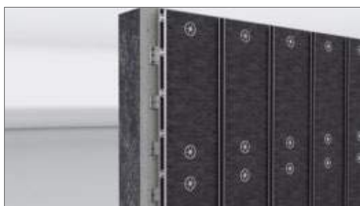
Fixer les agrafes de bordure avec des rivets aveugles en acier inoxydable (n° d'art. 675).
