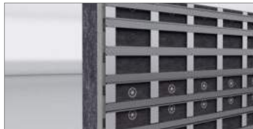
Monter le profilé porteur horizontal avec les moyens de fixation agréés.
