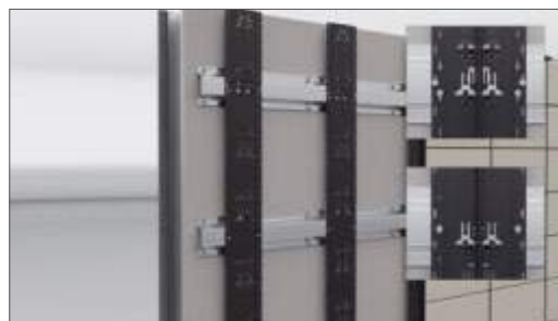
Fixer le profilé Oméga avec un rivet aveugle en aluminium (n° d'art. 658) ou une vis en acier inoxydable A4 (n° d'art. 659) (attention à l'agencement des points fixes et flottants).
