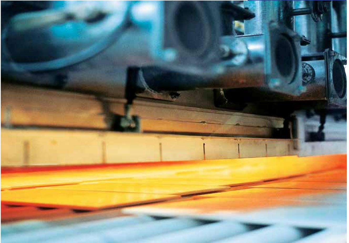
La méthode de fabrication céramique garantit une durabilité extrême. Le finissage HT est recuit à température élevée et se combine ainsi solidement avec la surface. Que ce soit sur des carreaux mats ou brillants, HT est pratiquement invisible.
